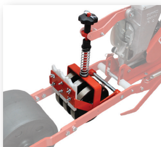
Нержавеющая сталь, трехрядный посев. ORIETTA Ш
